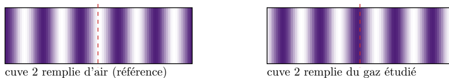
Fig. 9. – Champ de l'oculaire (schématique) : remplir la cuve 2 avec le gaz étudié décale les franges par rapport à leur position de référence (cuve 2 remplie d'air, tirets).
